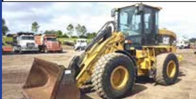
2005 CAT 924G EROPS, A/C, RIDE CONTROL, AUX HYD, Q/C, 20.5R25 RUBBER POR
