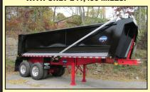
2020 RHODES 26' STEEL DUMP TRAILER AR450, DUAL HINGE HIGH LIFT-GATE, 70,000# SINGLE POINT, ELECTRIC COVER.
